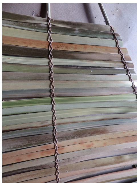
atado en cruz de la varilla central y las varillas laterales
